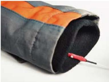
In einer Kooperation zwischen c.russ-NETCONSULT und dem Institut für angewandte Ergonomie ist die SWEATOR-Klimasimulation serienreif entwickelt worden. SWEATOR ist eine statische, quantitativ reproduzierbare Quelle für Feuchte und Wärme, die mit nahezu beliebigen Prüfkörperformen thermoregulative Prozesse nachbilden kann.
